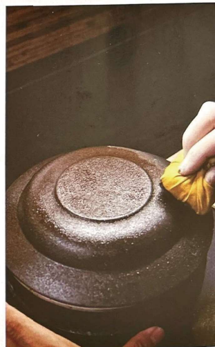
鉄を混ぜた漆をまんべんなく塗っ て傷を付きにくくする作業「古鉄（こ てつ）」。金属製のカトラリーに対 応させたいという要望に応える。
