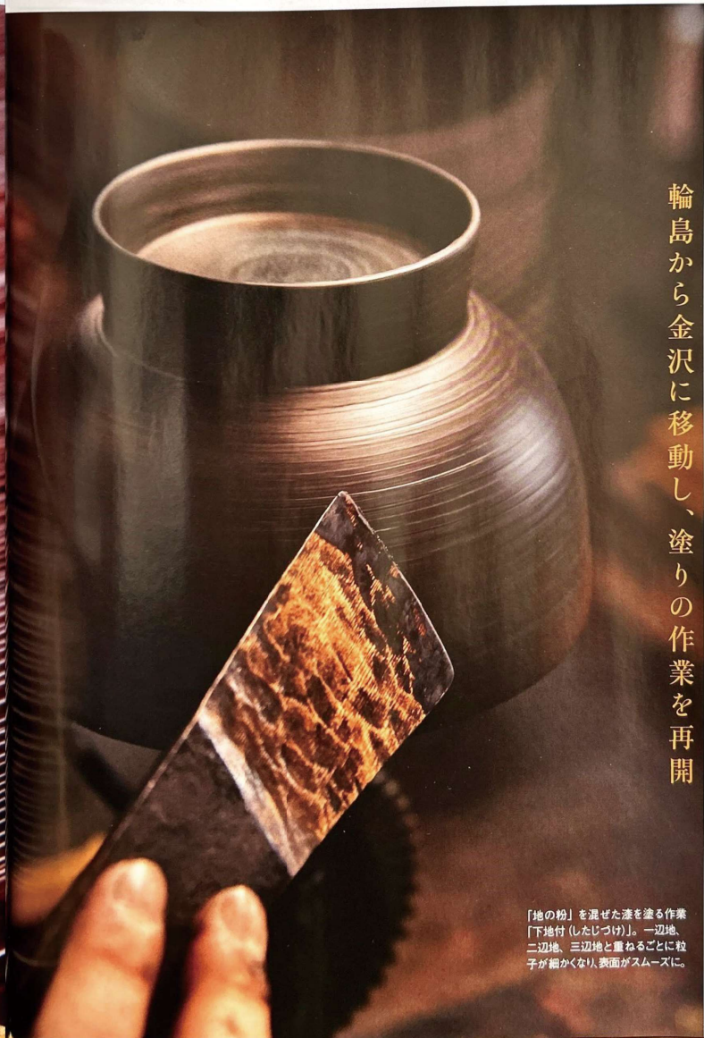
木粉を混ぜた漆を重箱の隅に塗っ て強度を高める作業「惣身付（そ うみづけ）」。木製のへらは自らの 手なりに合うように自作したもの。
