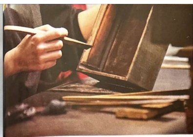
木粉を混ぜた漆を重箱の隅に塗っ て強度を高める作業「惣身付（そ うみづけ）」。木製のへらは自らの 手なりに合うように自作したもの。
